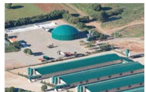
Explotación porcina con planta de Biogás de 250 KW.
